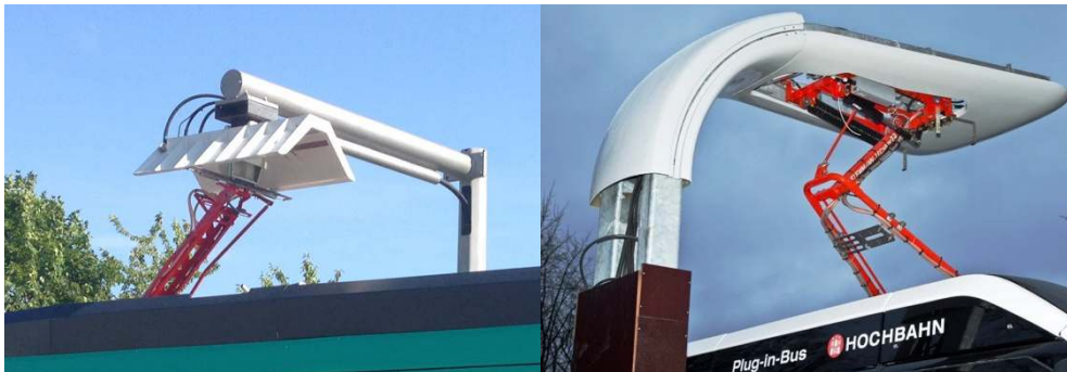
Abbildung 5: Dockings-Stationen - Stromabnehmer am Fahrzeug (links) und Stromabnehmer an der Ladestation (rechts)
